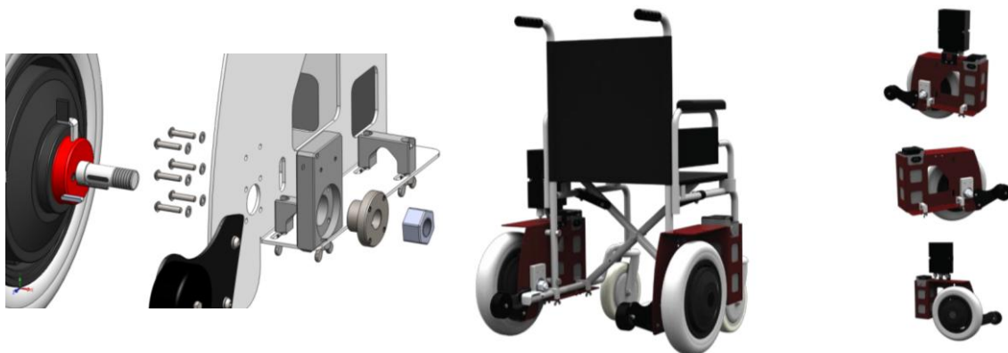
Figura 7 - Fixação do cubo (lado esquerdo) e 3D (lado direito) do conjunto do protótipo 2
