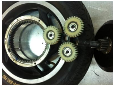
Figura 2 - Arquitetura interna do motor e sistema de transmissão
